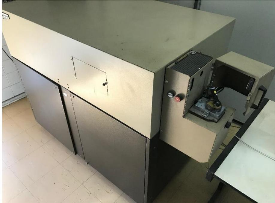
Figura 19 - Espectrômetro Ótico 3460 AES do Centro de Pesquisas da Companhia Siderúrgica Nacional (Adaptado de Companhia Siderúrgica Nacional).
