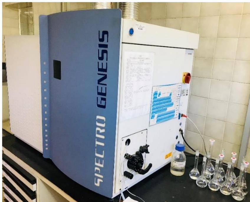
Figura 20 - Espectrômetro de Emissão Atômica com Plasma Acoplado Indutivamente, Modelo Genesis, do Centro de Pesquisas da Companhia Siderúrgica Nacional (Adaptado de Companhia Siderúrgica Nacional).
