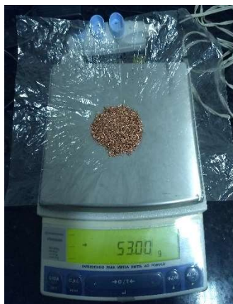
Figura 14 – Balança digital, modelo UW6200H, fabricante Shimadzu. Carga máxima de 6200g e carga mínima de 0,5g.
