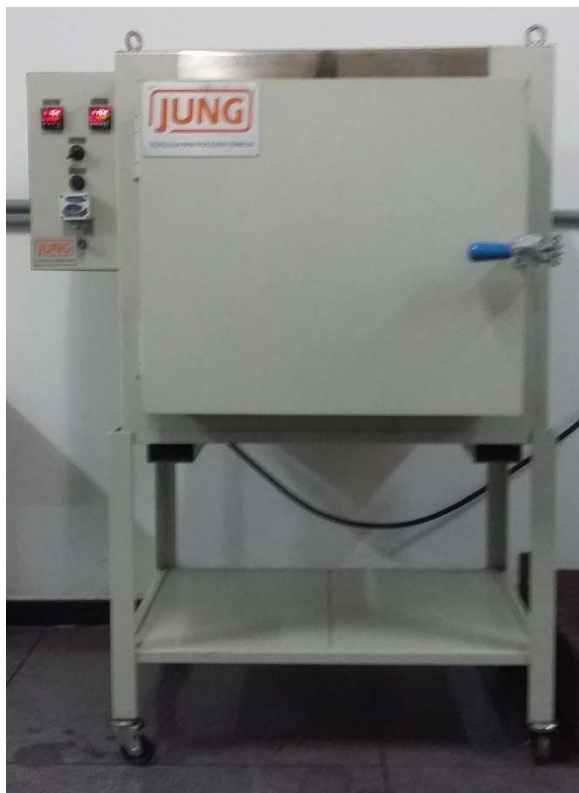
Figura 16 – Forno elétrico tipo mufla, modelo FE7013, fabricante Jung. Temperatura máxima 1300°C.
