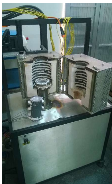
Figura 19 – Fornos de solidificação direcional vertical, modelo FSD1200V, fabricante ForteLab. Temperatura máxima 1200°C.
