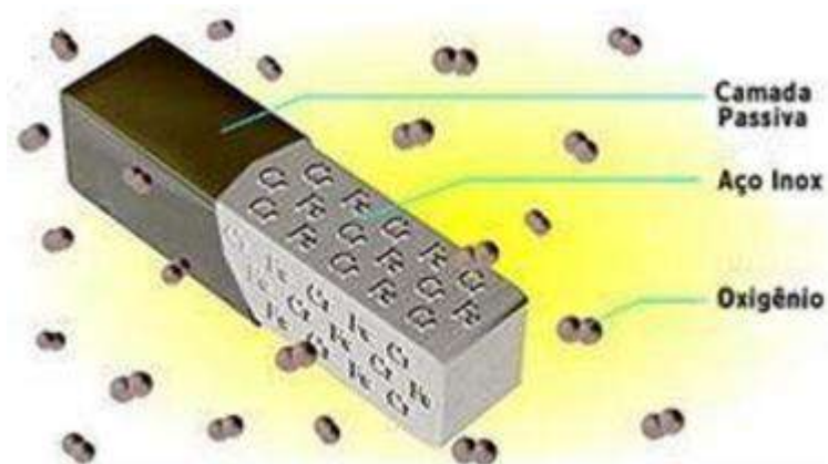
Figura 1. Formação da camada passivadora de óxido de cromo ( \text{Cr}_2\text{O}_3 ) (LIMA, 2011).
