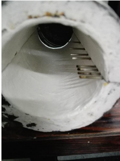
Figura 21 - Molde revestido de alumina com os termopares posicionados nas posições pré-determinadas.
