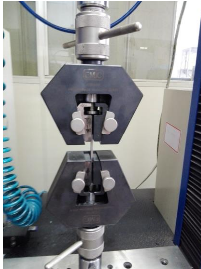
Figura 27 - Corpo de prova preso às garras da máquina de ensaio universal EMIC.
