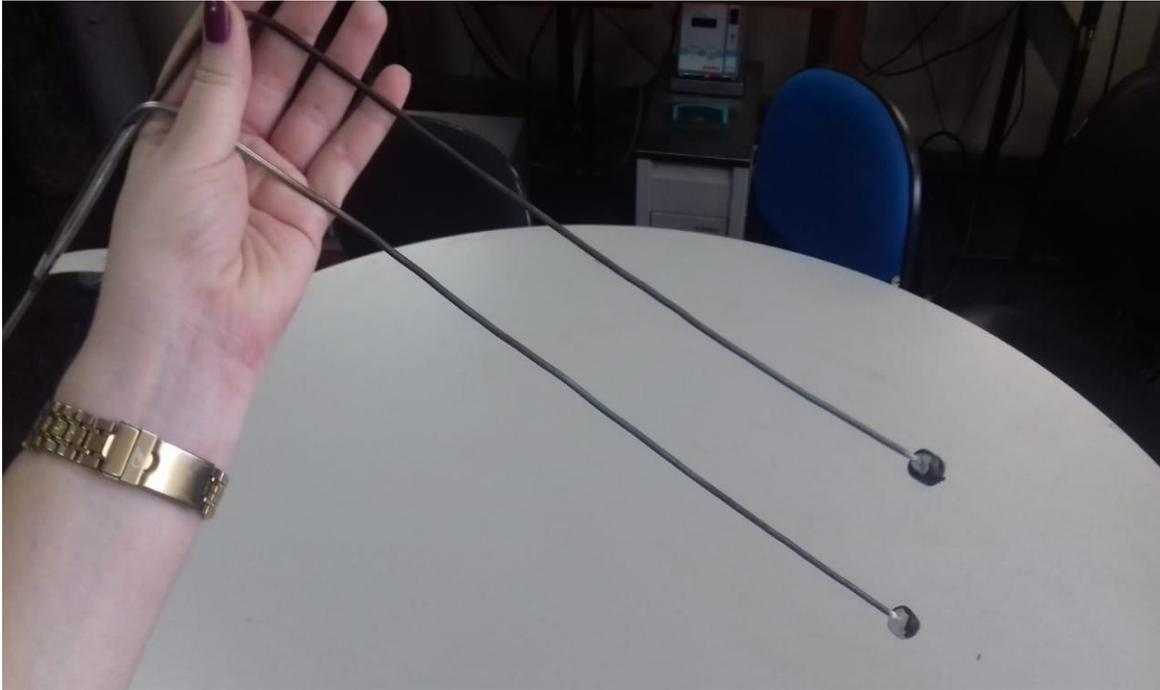
Figura 40 – Briquetes com termopares inseridos em seu interior para medição de perfil térmico.
