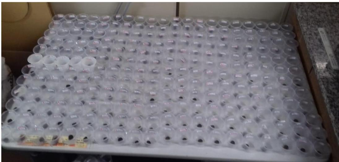
Figura 35 – Identificação dos briquetes após confecção e secagem.
