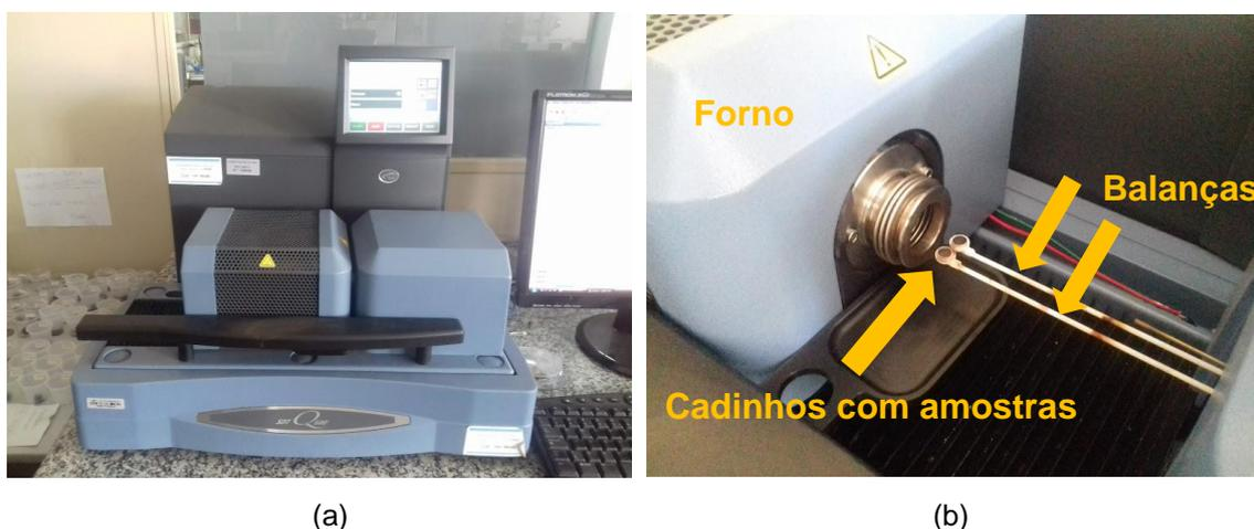
Figura 45 – (a) Equipamento TGA utilizado para o ensaio; (b) Imagem do forno aberto, com as balanças expostas.
