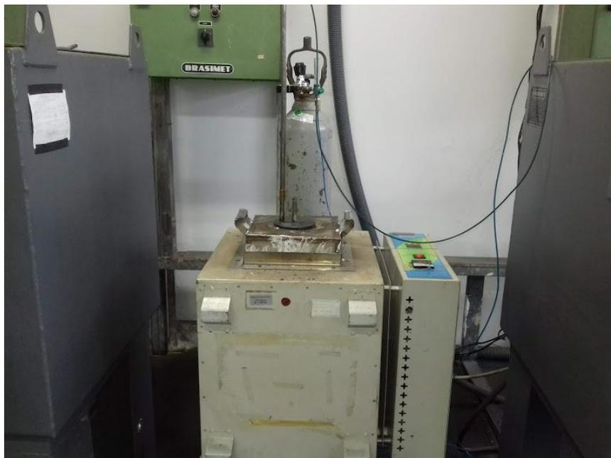
Figura 37 – Forno de mufla utilizado neste trabalho com cuba de inox em seu interior, durante ensaios.
