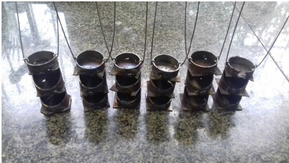
Figura 38 – Suportes em aço utilizados para colocar as amostras no interior da cuba durante os ensaios em forno.
