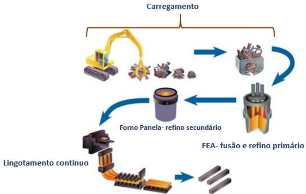
Figura 3 – Ciclo de produção com forno elétrico. Adaptado de (49)
