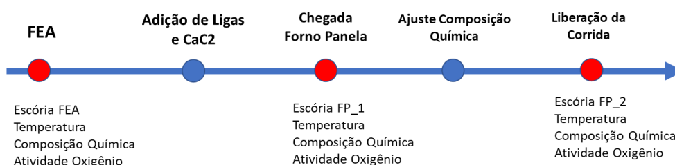
Figura 19 - Sequência de Amostragem para Identificação das Variáveis Críticas de Vazamento
