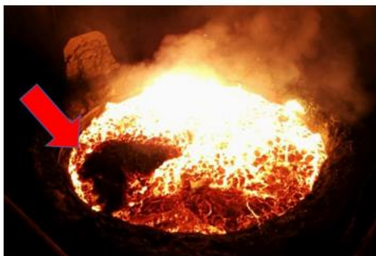
Figura 31 - Fração sólida na escória na chegada ao forno panela
