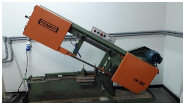
Figura 3-2 - Serra Fita (Laboratório de Solidificação -EEIMVR/UFF)
