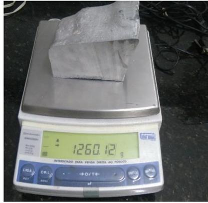
Figura 3-3 – Balança digital de precisão (Laboratório de Solidificação Unidirecional – EEIMVR/UFF)
