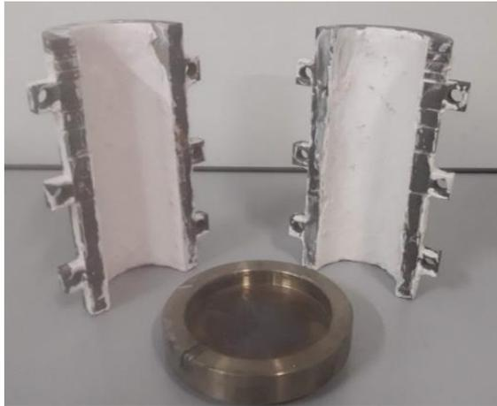
Figura 3-6 – Molde Bipartido Revestido com Camada de Alumina e Base – Laboratório de Solidificação
