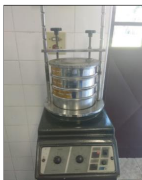
Figura 18 – Mesa vibratória com as peneiras, fundo e tampa utilizados na separação granulométrica.
