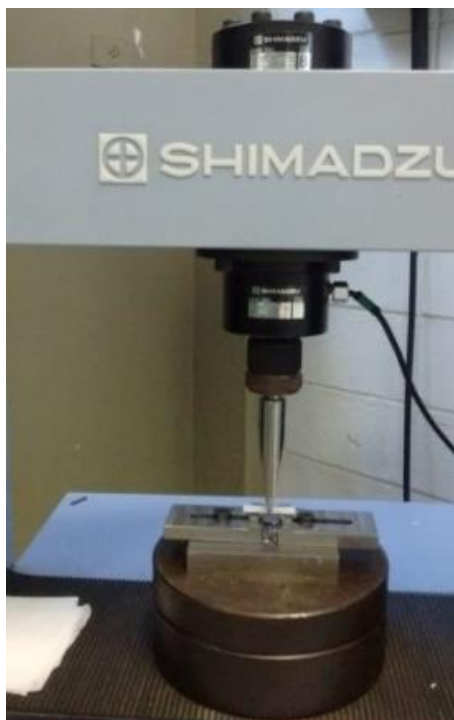
Figura 41 - Ensaio de flexão em 3 pontos.
