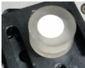
Figura 31 - Aparência final de uma das amostras embutidas após a preparação ceramográfica.
