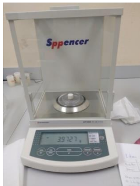
Figura 28 - Balança da marca Sp Spencer com precisão de 0,0001g.
