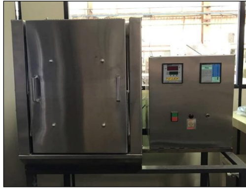
Figura 24 - Forno elétrico utilizado na queima das amostras.
