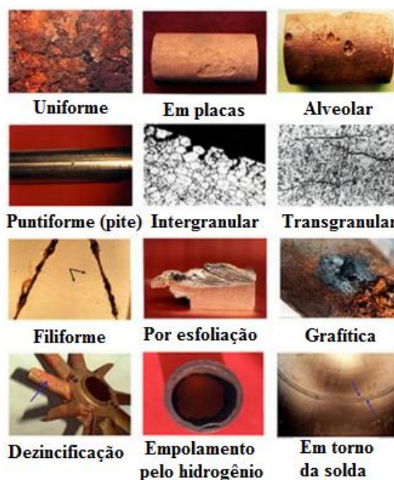
Figura 4: Diferentes tipos de corrosão
