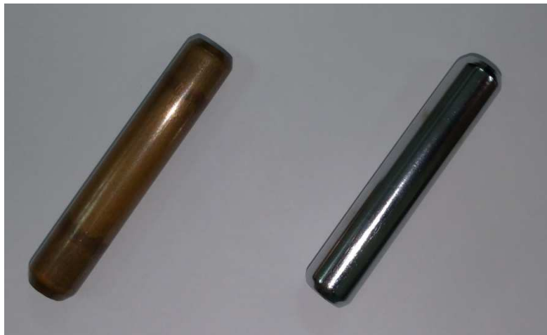
Figura 31: Mandril sem Revestimento (Avermelhado) e Mandril com Revestimento (Prateado).
