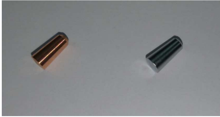
Figura 28: Eletrodo de sem Revestimento (Avermelhado) e Eletrodo com Revestimento (Prateado).
