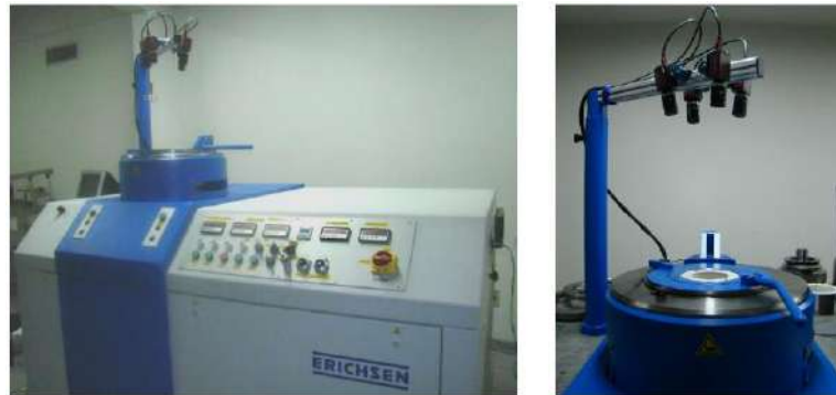
Figura 26 - Aspecto das câmeras do AutoGrid In-process posicionadas sobre o cabeçote uma prensa universal de estampagem Erichsen. Tepedino e colaboradores et al. (2012).
