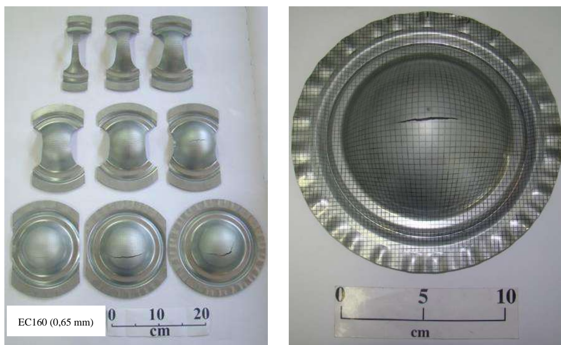
a) Aspectos dos corpos de prova estampados por punção
