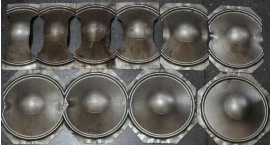
Figura 22 – Aspecto de corpos de prova conformados pela técnica Nakajima modificado para a determinação de Curva Limite de Conormação de alo Livre de Intersticiais. Freitas et al. (2010).
