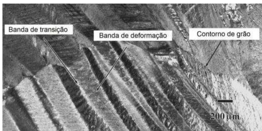
Figura 8: Bandas de transição em uma liga Al-Cu após compressão uniaxial a temperatura ambiente [40].
