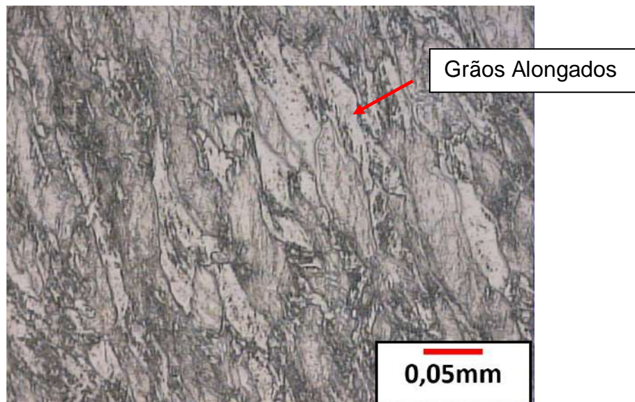
Figura 33: Micrografia após o terceiro passe da rota B A da secção transversal (plano TD-ND). Microscópio Óptico com ampliação de 200X.
