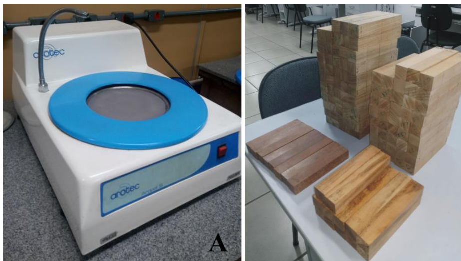
Figura 3.5: (A) Politriz utilizada na preparação da superfície dos corpos de prova. (B) Corpos de prova das espécies amazônicas examinadas.
