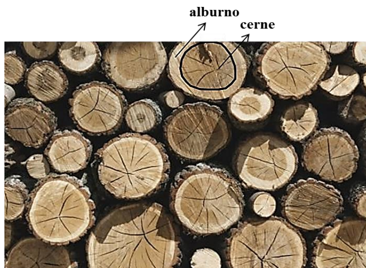
Figura 2.4: Cerne e alburno (Fonte: https://www.anpm.org.br/conheca-caracteristicas-da-madeira/ )
