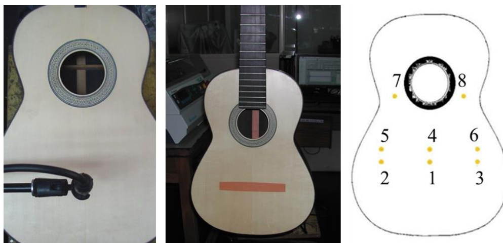
Figura 3.2: À esquerda, caixa de ressonância isolada; no meio, violão sem ponte (local de anexação da ponte indicado em laranja); à direita, pontos de aplicação dos impulsos.
