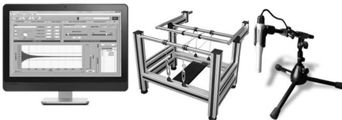
Figura 3.7: Sistema Sonelastic para aplicação da técnica de excitação por impulso em corpos de prova de tamanho médio
