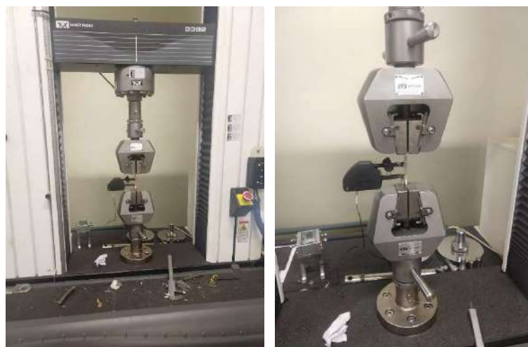
Figura 28 – (a) Máquina hidráulica INSTRON 3382 (b) detalhe do extensômetro (DIEMP-INT).
