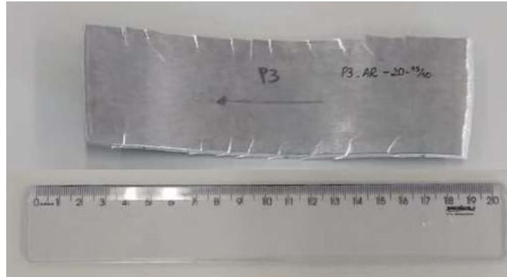
Figura 22 – Teste 3: laminação em único passe com 20% de redução na espessura e razão de assimetria 3/2 (15 rpm / 10 rpm).
