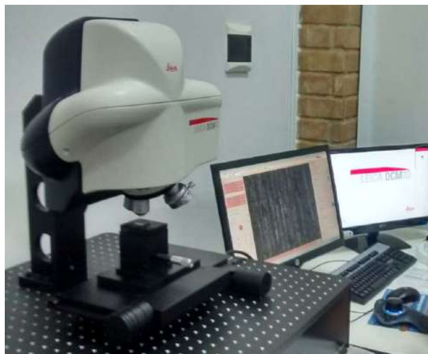
Figura 32 - Microscópio Confocal Interferométrico Leica DCM 3D (LMCM-ICEx).
