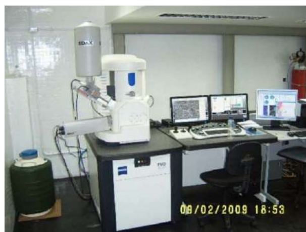
Figura 26 – Microscópio Eletrônico de Varredura EVO MA 10 (LMME-UFF).
