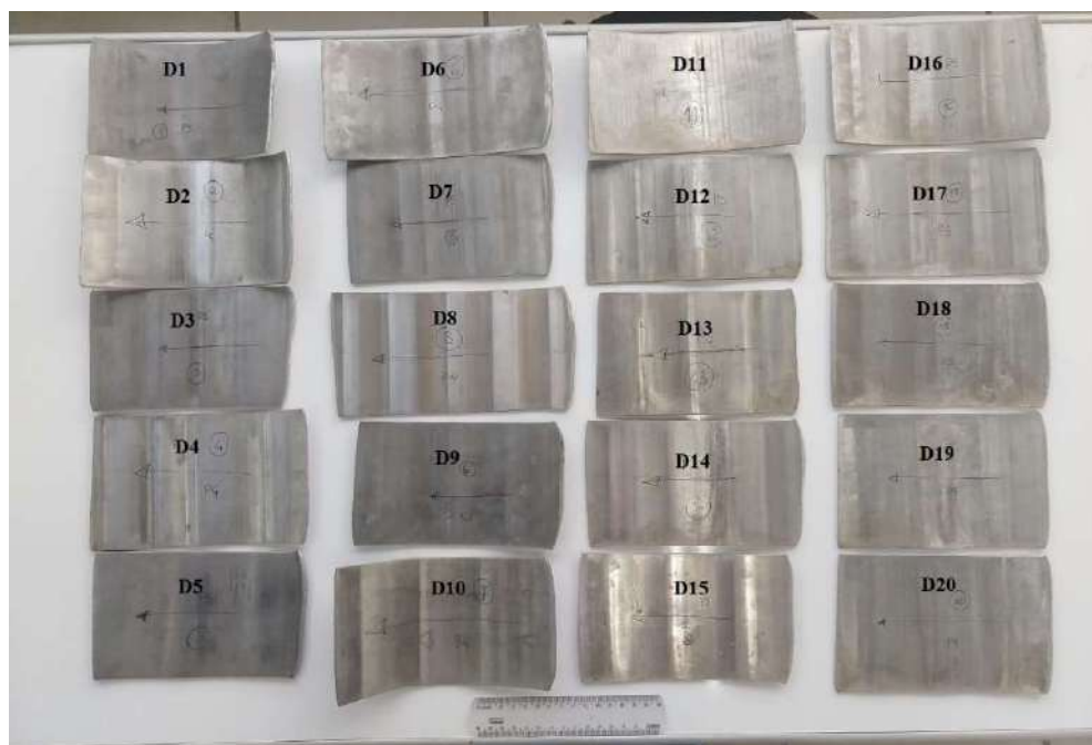
Figura 73 – Amostras laminadas em múltiplos passes conforme planejamento estatístico de experimentos.
