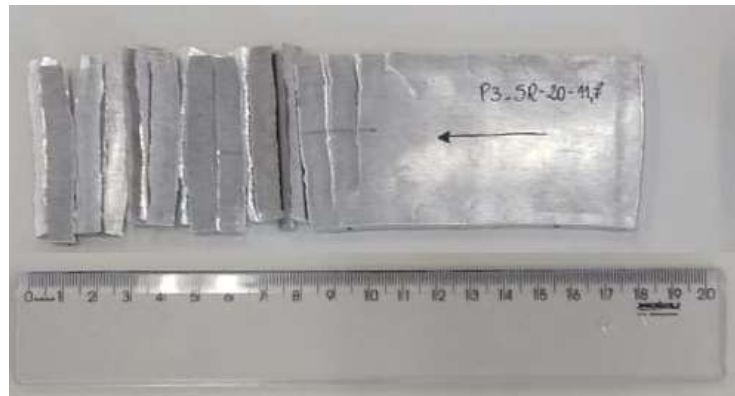
Figura 23 - Teste 4: laminação em único passe com 20% de redução na espessura em condição simétrica (velocidade dos cilindros = 11,7 rpm).
