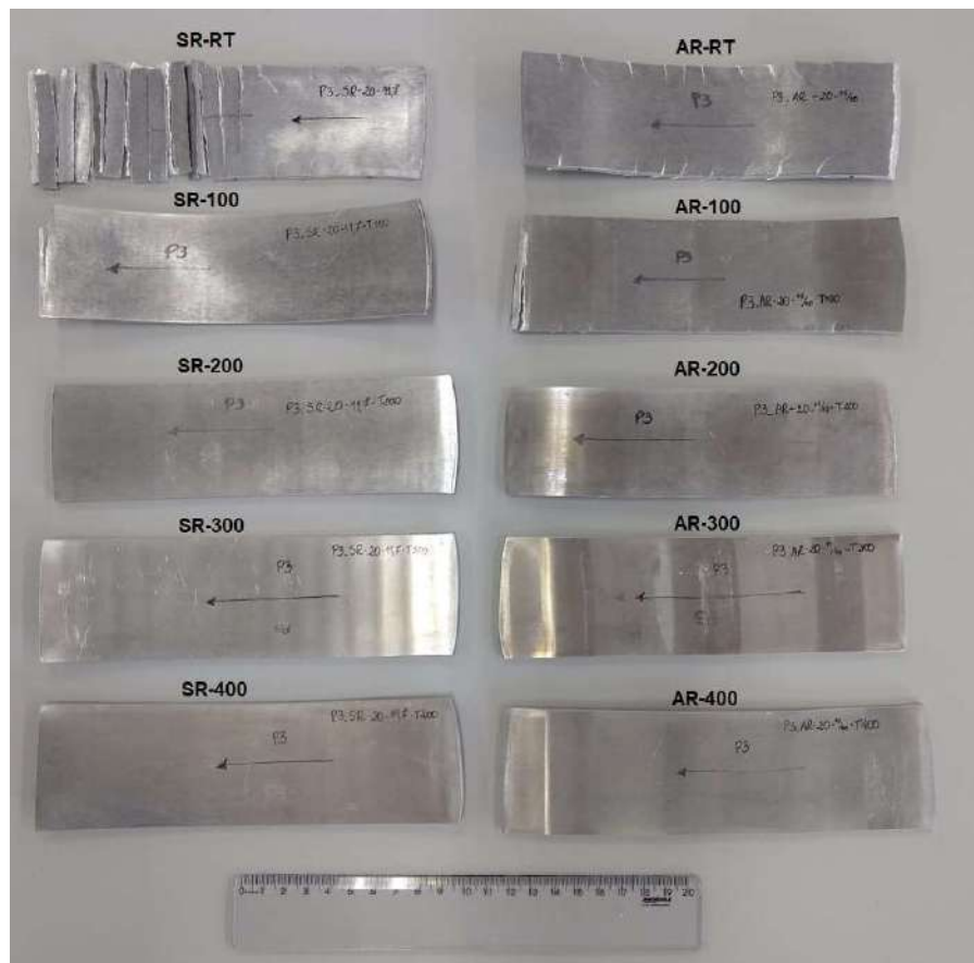
Figura 58 – Amostras laminadas em único passe, com redução planejada de 20% da espessura, em condições simétrica (SR) e assimétrica (AR) e diferentes temperaturas (RT, 100 °C, 200 °C, 300 °C e 400 °C).
