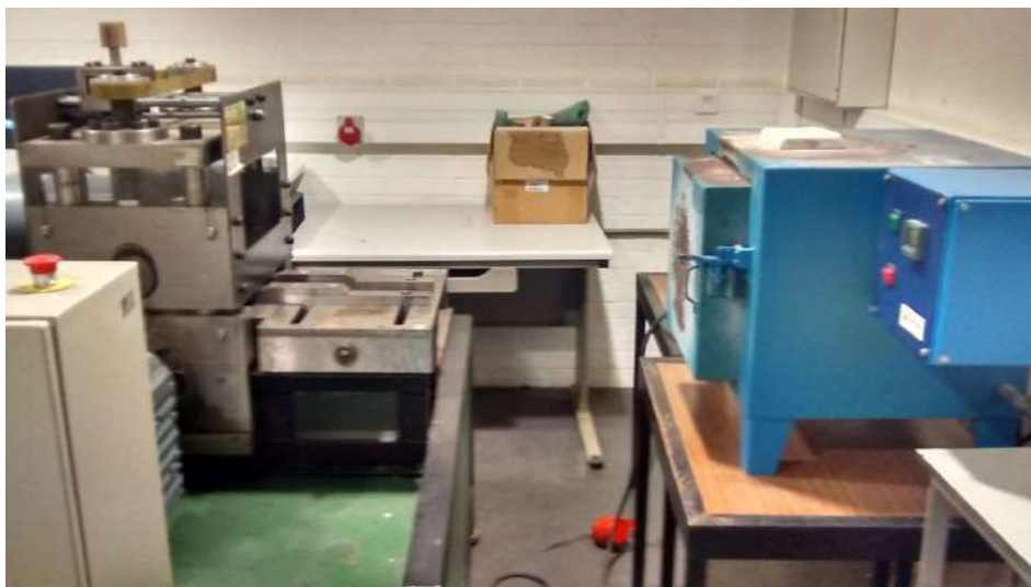
Figura 19 – Forno posicionado à frente do laminador (TEMA-UA).
