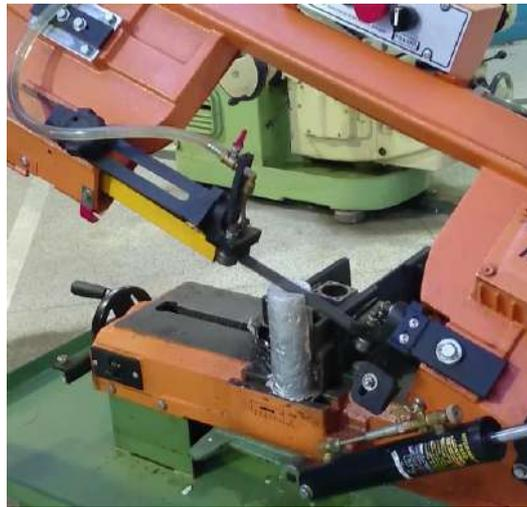
**Figura 4.4** Cortes longitudinais no centro do lingote.
