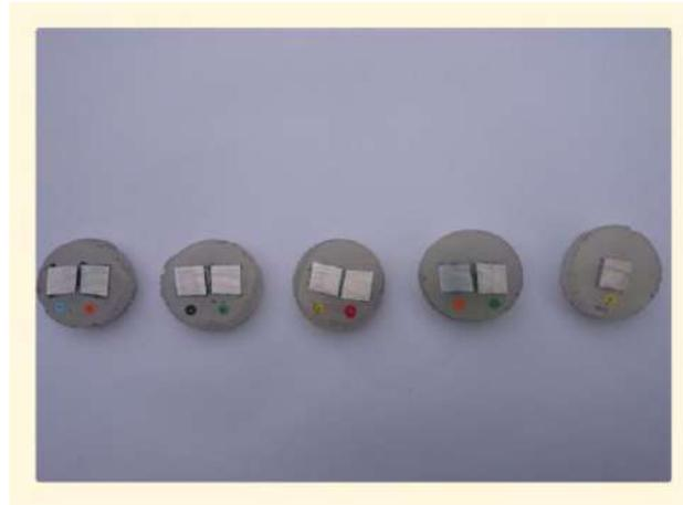
**Figura 4.8** Amostras embutidas a frio para determinação dos espaçamentos dendríticos.
