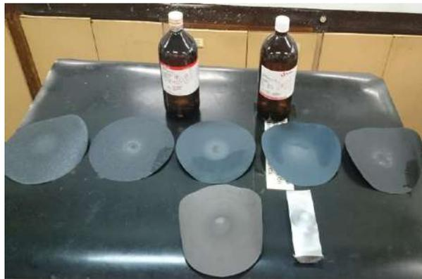
**Figura 4.5** Preparação da amostra para ataque químico e revelação da macroestrutura.
