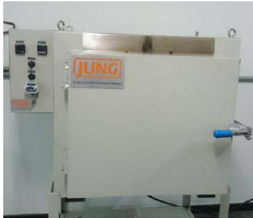
**Figura 4.1** Forno tipo câmara, da marca Jung, modelo 7813.
