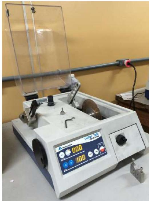
**Figura 4.7** Serra de precisão da Buehler com disco de diamante para realização dos cortes transversais.
