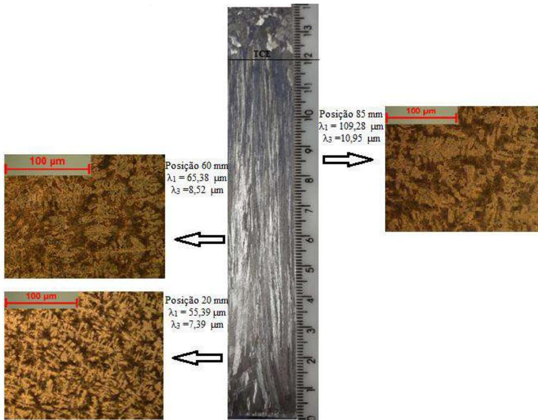
**Figura 5.59** Macroestrutura e Microestrutura de Solidificação.
