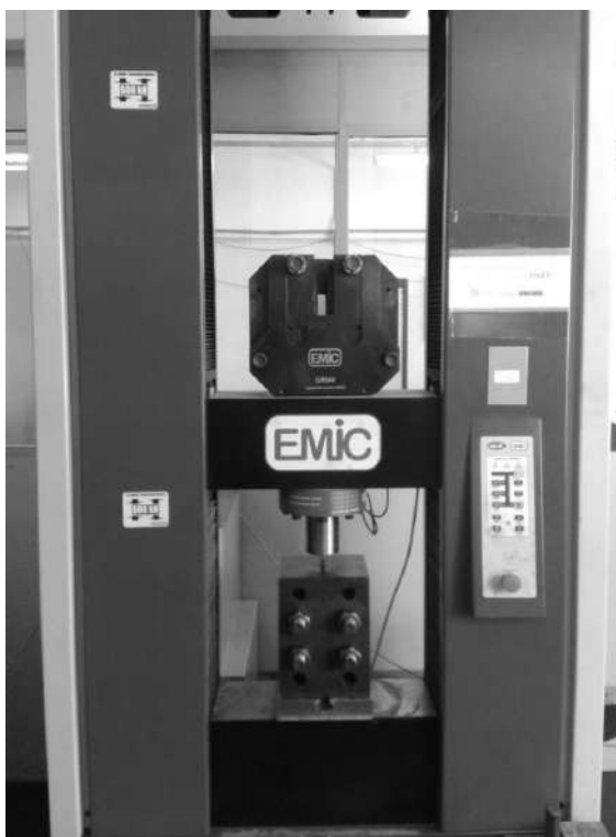
Figura 8: Sistema ECAP mostrando o processo de deformação do tarugo.
