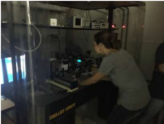
(a) Ajuste dos espelhos e câmera CCD.
